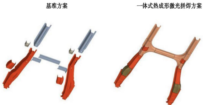
图表 26 一体式热形成激光拼焊方案应用：H 梁
